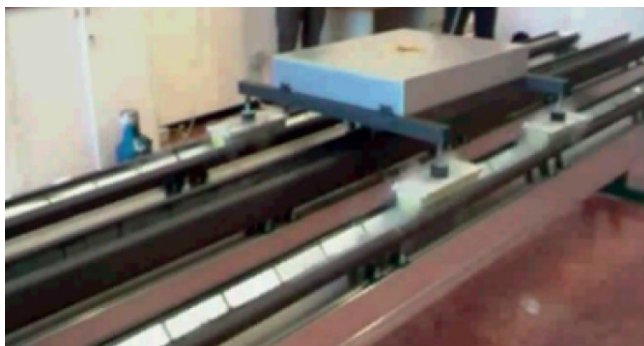
Figura 16a – Sistema sperimentale - Sistema Maglev italiano UAQ4.
