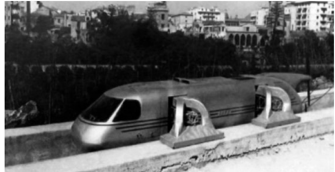
Figura 3b – Treno IAP2 (Italia) - Sistema sperimentali TACV.
