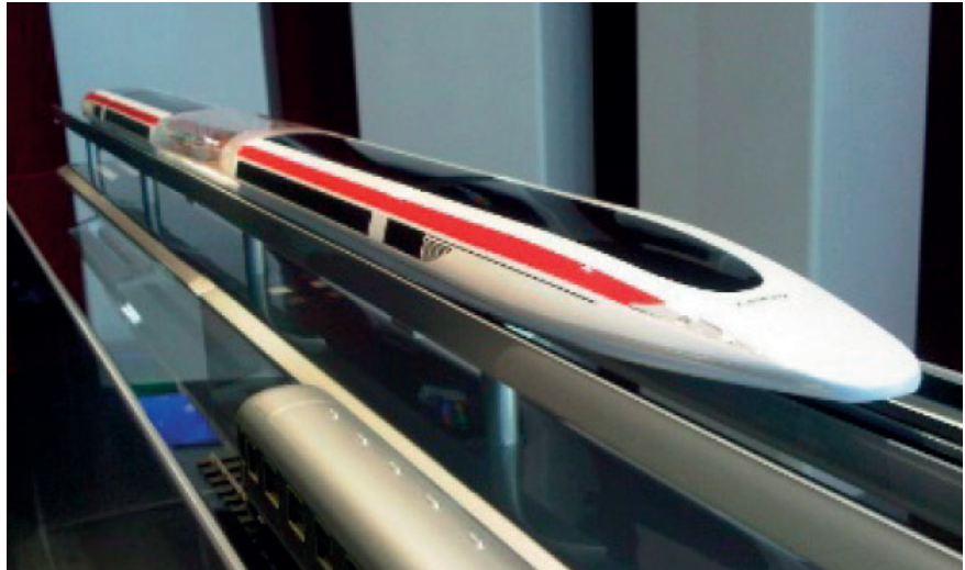
Figura 16c – Modello (scala 1:20): della versione ad alta velocità - Sistema Maglev italiano UAQ4.
