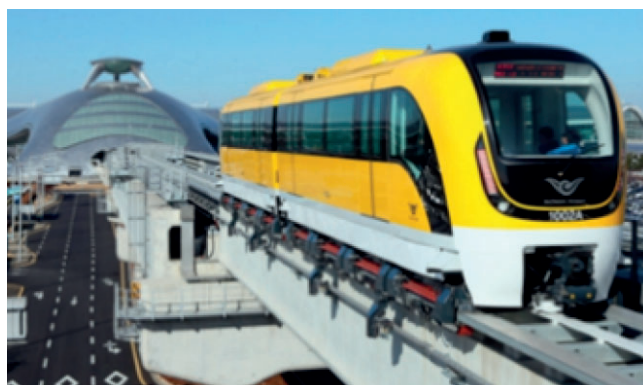
Figura 10b – Linea Maglev in Incheon, Corea - Applicazione EMS per medio-basse velocità.
