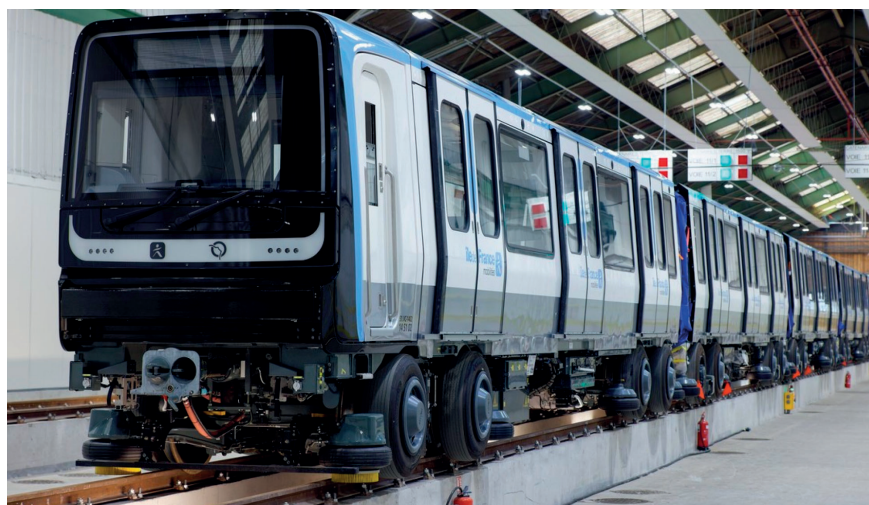
Figura 2 – Metro automatiche ma anche dotate di cabina di guida per la linea 11 della rete Île-de-France Mobilités gestita da RATP.
