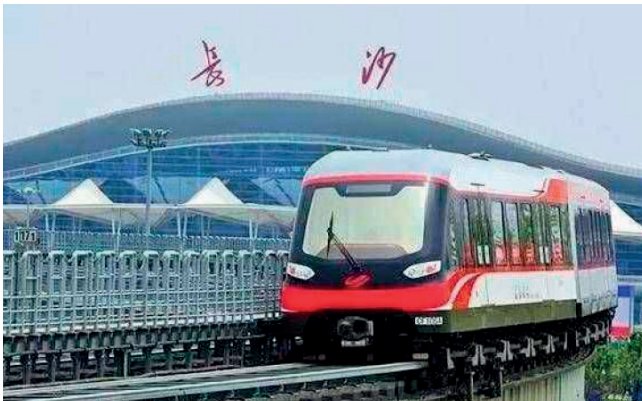
Figura 10c – Linea Maglev in Changsha, Cina - Applicazione EMS per medio-basse velocità.
