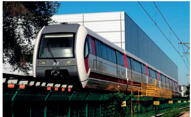
Figura 10d – Linea Maglev line in Pechino, Cina - Applicazione EMS per medio-basse velocità.
