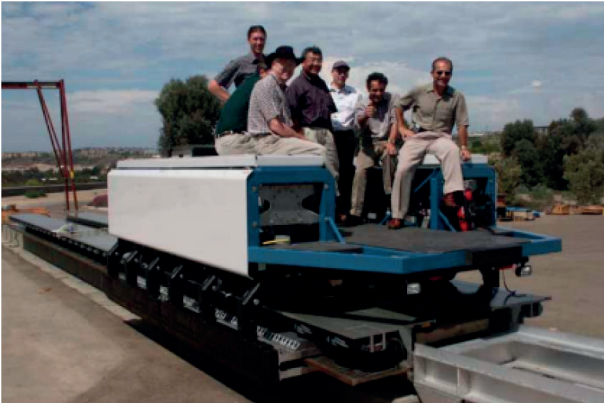
Figura 12b – Prototipo Inductrack a medio-basse velocità (US) - Applicazione EDS.
