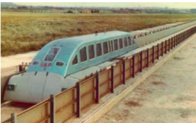
Figura 3c – Treno IAP3 (Italia) - Sistema sperimentali TACV.
