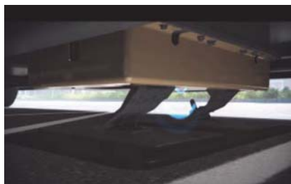
Fig. 9 – Sistema per contatto per ricarica elettrica del veicolo. Fig. 9 - Contact system for electric vehicle charging.
