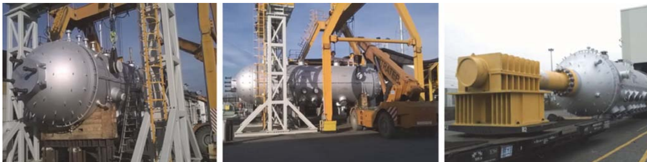
Fig. 2 - Il reattore installato sul carro di trasporto.
