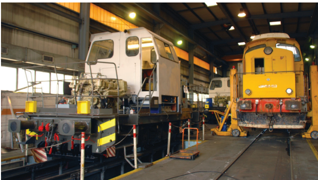
Fig. 3 – Locomotori LHB nelle Officine MaReSer di Genova in avanzata fase di aggiornamento (Cortesia: R. GENOVA).
