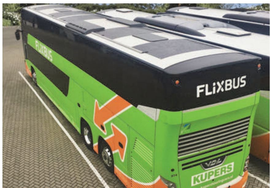
Figura 3 – Un FlixBus che mostra i pannelli solari installati sul tetto.
