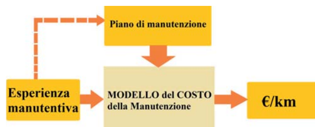
Fig. 7 - Attraverso il ritorno di esperienza dal campo si correggono le assunzioni presenti nel Modello del Costo della Manutenzione e si applica la revisione del Piano di manutenzione per adeguare gli interventi al reale stato degli asset.
