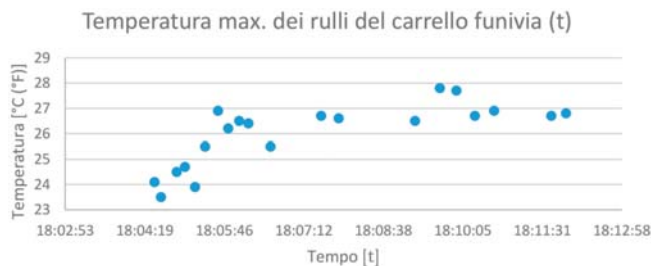
Fig. 14 - Tendenza della temperatura durante l'arresto della funivia alla stazione.
