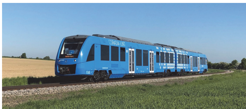
Figura 2 – Treno a celle a combustibile ad idrogeno Coradia iLint sui 65 chilometri di linea tra Groningen e Leeuwarden nel nord dei Paesi Bassi. Figure 2 – Coradia iLint hydrogen fuel cell train on the 65 kilometres of line between Groningen and Leeuwarden in the north of the Netherlands.
