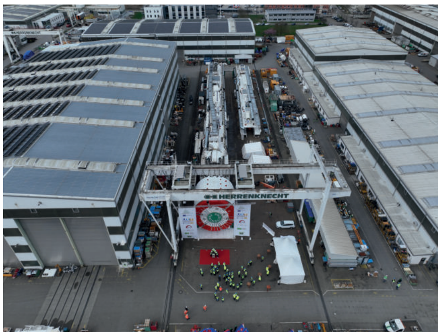
Figura 3 – È stata presentata nello stabilimento Herrenknecht in Germania la prima delle due maxi frese destinate a scavare il versante italiano del tunnel di base del Moncenisio della nuova linea ferroviaria Torino-Lione. La TBM, lunga come due campi da calcio e dotata di una testa dal diametro di 10,16 m, è destinata al cantiere di Chiomonte, in Val di Susa, dove realizzerà la seconda discenderia prima di proseguire con lo scavo della galleria sud del tunnel di base.
