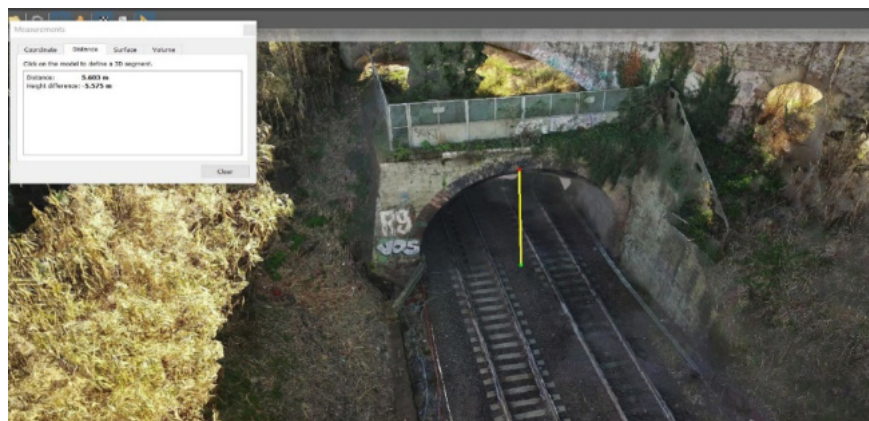
Figura 12 - Mash 3D, misurazione altezza galleria. Figure 12 - 3D mash, tunnel height measurement.
