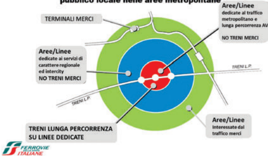
Figura 16 – Modello delle infrastrutture di trasporto nelle aree metropolitane. Figure 16 – Model of transport infrastructures in metropolitan areas.
