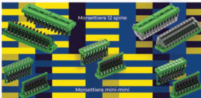
Con il tempo e per necessità mutate le morsettiere sono state ridotte negli ingombri ed adattate con particolari morsetti a codolo saldabili (ns. brevetto) ed installate direttamente su schede elettroniche (PCB) diversificandole per numero di morsetti presenti, da 12 morsetti, da 8 morsetti, da 4 morsetti e da 2 morsetti con la possibilità di accoppiarle secondo la necessità del progetto rendendole modulari.
