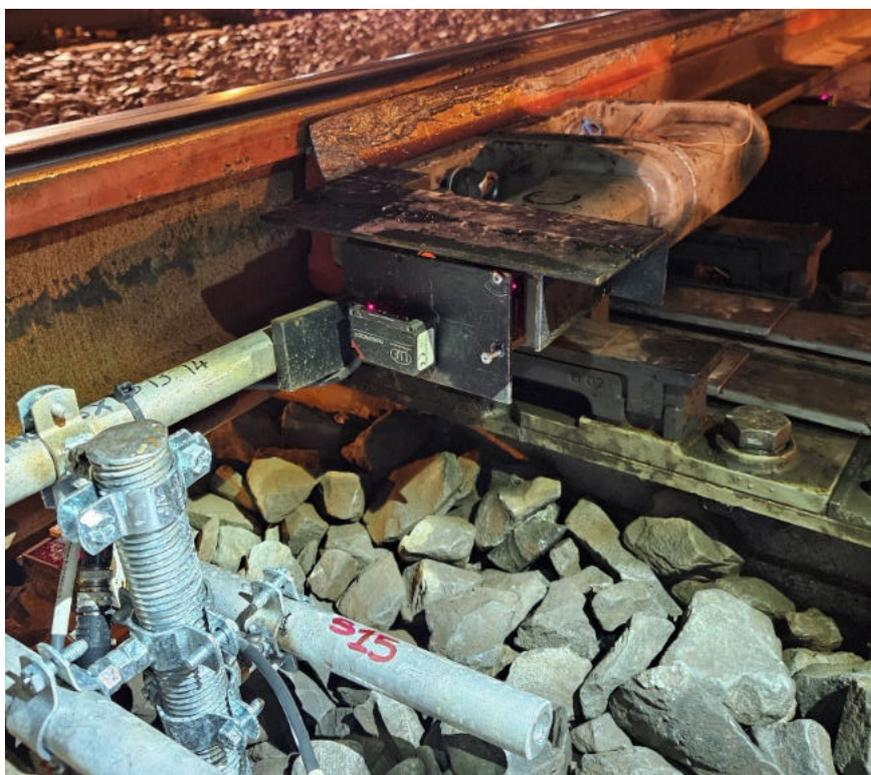
Figura 5 – Sensori laser per il monitoraggio degli spostamenti in punta
