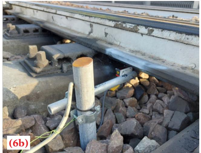
Figura 6 – Accelerometri (6a) e sensori laser (6b) installati per il monitoraggio.
