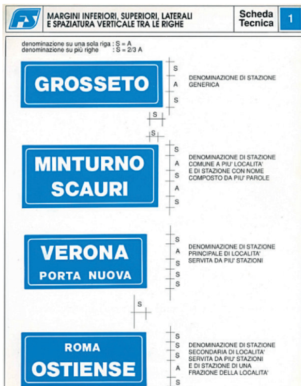
Figura 28 – Esempio di scheda tecnica relativa alle proporzioni dei caratteri per il “nome stazione”.
