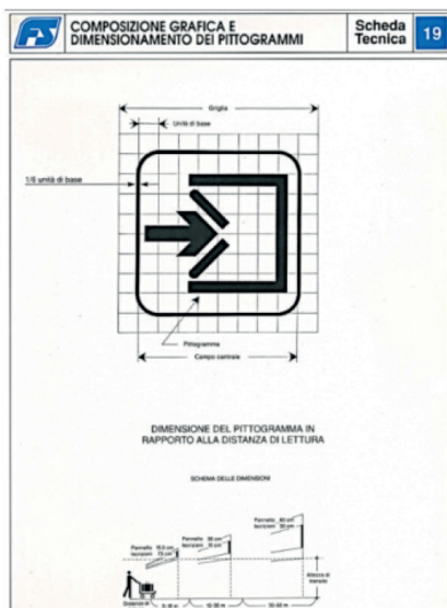
Figura 30, Figura 31 e Figura 32 – Esempi di schede relative al dimensionamento dei pittogrammi e dei pannelli in rapporto alla distanza di lettura (da 5 a 50 m) e composizione grafica di pannelli con pittogrammi ed iscrizioni complementari.
