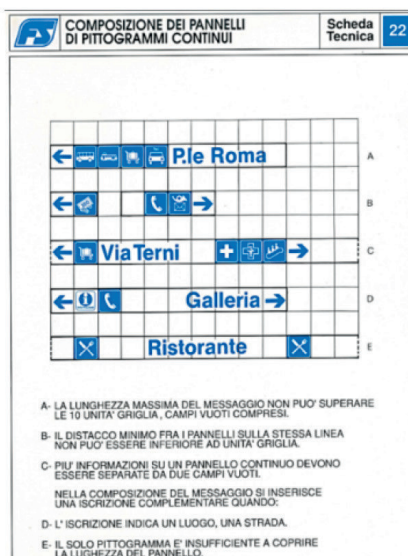
Figura 30, Figura 31 e Figura 32 – Esempi di schede relative al dimensionamento dei pittogrammi e dei pannelli in rapporto alla distanza di lettura (da 5 a 50 m) e composizione grafica di pannelli con pittogrammi ed iscrizioni complementari.
