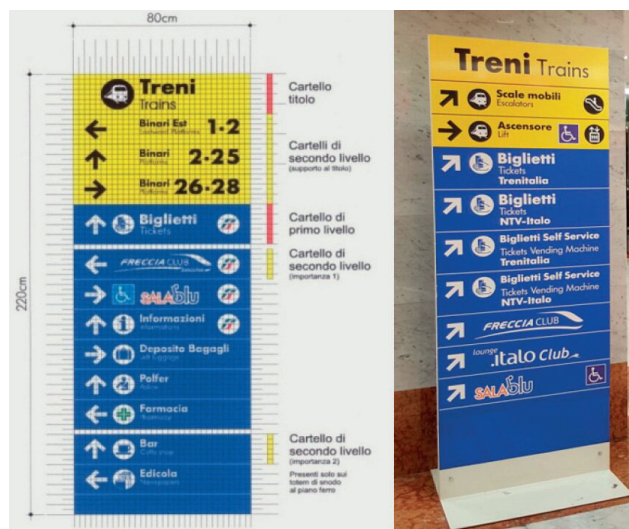
Figura 64 e Figura 65 – Schema grafico totem e vista realizzazione. Figure 64 and Figure 65 – Totem graphic diagram and embodiment view.
