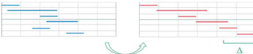
Figura 8 – Esempio schematico di diagrammi di Gantt del medesimo intervento con attività in parallelo o in serie.
