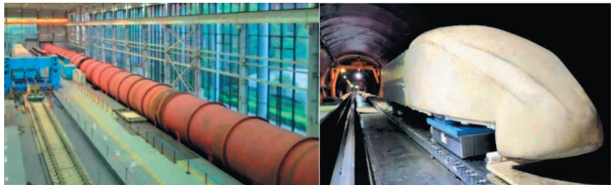
Figura 24 – Piattaforma di prova multifunzionale per il sistema maglev SML-ETT con velocità di 430 km/h.
