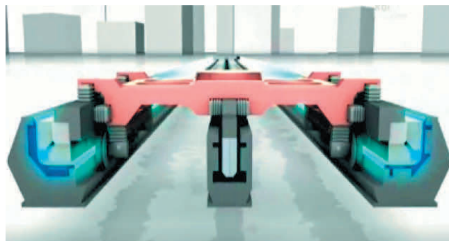
Figura 16b – Rappresentazione degli apparati di sospensione e propulsione - Sistema Maglev italiano UAQ4.
