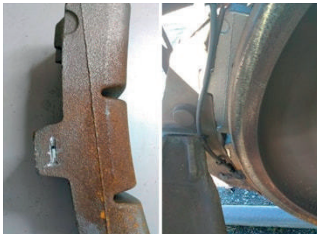
Fig. 7 - Sensorizzazione suola freno. Fig. 7 - Brake block sensorization.
