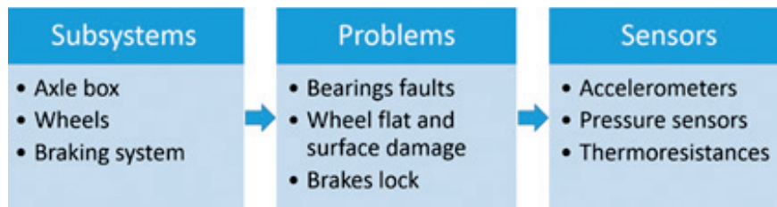
Fig. 1 - Sottosistemi del veicolo: diagramma e possibili guasti. Fig. 1 - Vehicle subsystems: diagram and possible failures.
