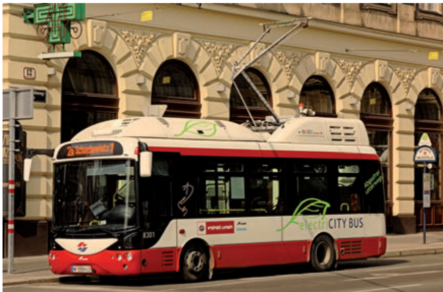
Fig. 4 - Autobus elettrico con ricarica mediante pantografo a Vienna (Cortesia: Prof. Riccardo GENOVA).
