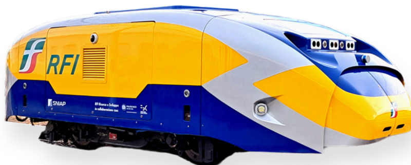
Figura 1 – Il prototipo di veicolo ferroviario a guida autonoma TINO (URV). Figure 1 – The TINO (URV) self-driving railway vehicle prototype.
