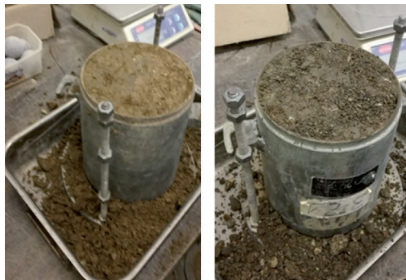
Figura 5 - Preparazione dei provini con costipatore Proctor e con Vibrating Hammer.
