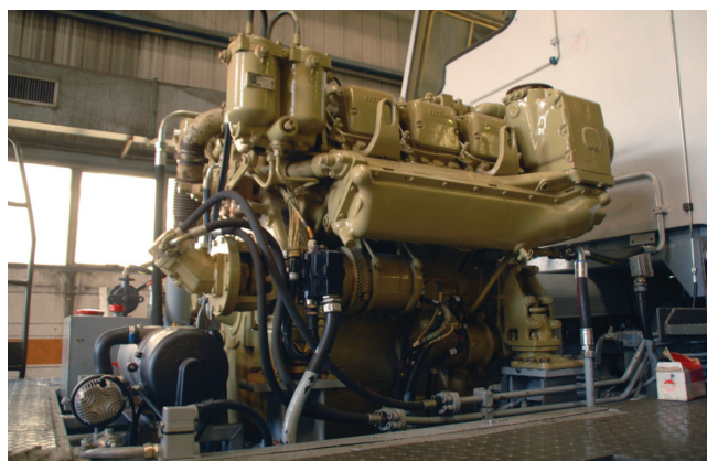
Fig. 2 – Motore revisionato e già calato sulla LHB 509 - Officine MaReSer di Genova – Genova 6 luglio 2018 (Cortesia: R. GENOVA).
