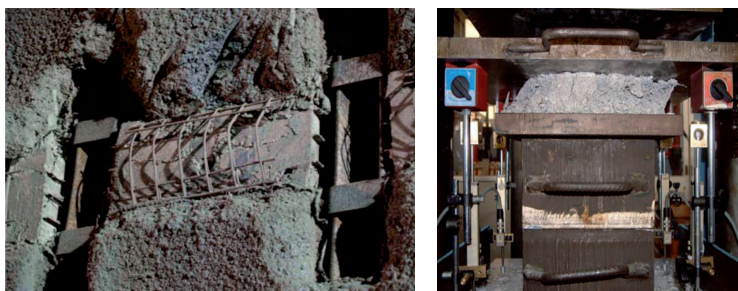
Fig. 13 – (a) Rivestimento deformabile con elementi HiDCon; (b) Dettaglio di un elemento HiDCon alla massima deformazione nel corso di una prova nel laboratorio MASTRLAB del Politecnico di Torino. (a) Deformable lining with HiDCon elements, (b) Detail of a HiDCon element at maximum strain during testing in the MASTRLAB laboratory, by Politecnico di Torino.
