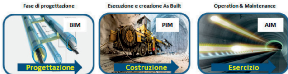
Figura 1 – Evoluzione di un modello informativo - dalla fase di progettazione (BIM) alla fase costruzione (PIM), giungendo infine alla fase di esercizio (AIM).
