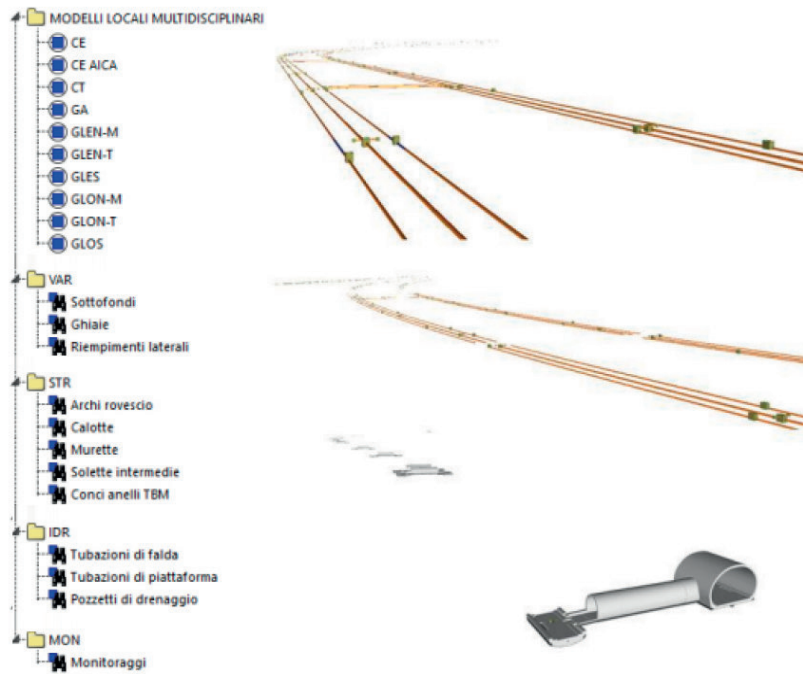
Figura 25 – Suddivisione del modello di coordinamento in tratte e gruppi per il loro successivo utilizzo nell’individuazione delle interferenze e delle incoerenze.
