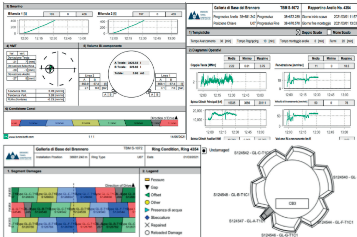
Figura 4 – Esempio di Report Anello estratto dalla TBM con il set di parametri fisici e meccanici registrati anche all'interno del singolo concio nel modello informativo.
