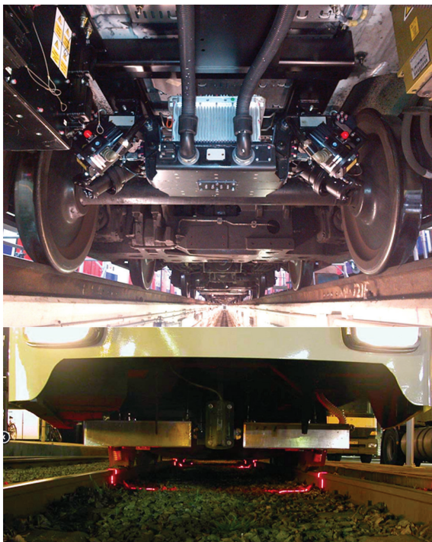
Figura 6 – Sistema UGMS MERMEC basato sul metodo inerziale (in alto) e sul metodo corda-freccia (in basso).
