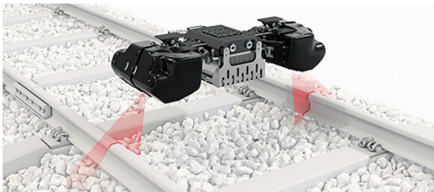
Figura 5 – Sistema di monitoraggio della geometria del binario composto da un'unità inerziale e due sensori ottici.
