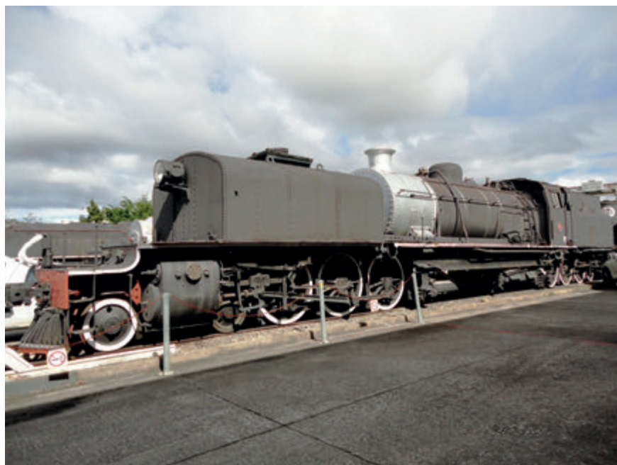
Fig. 29 - La possente locomotiva a vapore "Garrant" classe GL" del 1929 che costituiva l'ossatura del sistema ferroviario sudafricano. Pesava 211 tonnellate con un'autonomia di 800 km grazie alle scorte d'acqua consentite dal serbatoio posizionato sulla testata. Nonostante la lunghezza di 28 m aveva una grande capacità d'iscrizione in curva grazie alla particolare soluzione "Garrant" che prevedeva la suddivisione del carrello in due sezioni pivotanti, disposte alle due estremità anteriori e posteriori della locomotiva. Lo scartamento era quello denominato "Cap Gauge", avente la misura di 1.067 mm.
