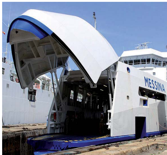
Fig. 16 – Celata di prua della nave "Messina". Fig. 16 – Bow's beak of "Messina" ship.
