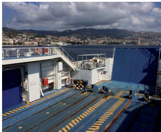
Fig. 18 – Rampa di poppa. Fig. 18 – Stern's ramp.
