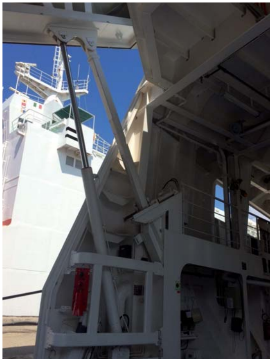
Fig. 17 - Cilindri per l'apertura della celata. Fig. 17 - Cylinders for the bow's beak opening.
