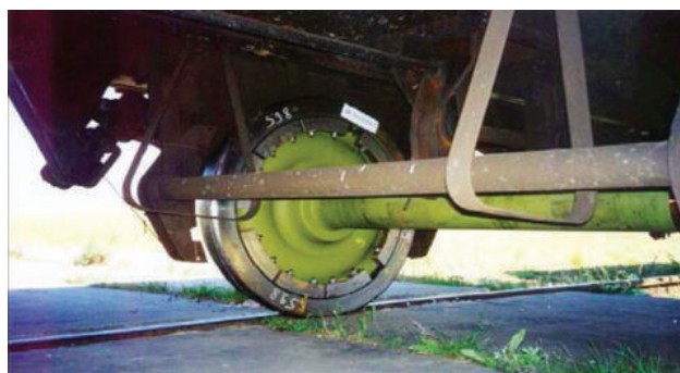
Fig. 8 – Ruota silenziata con assorbitori acustici. Fig. 8 – Silenced wheel with acoustic absorbers.
