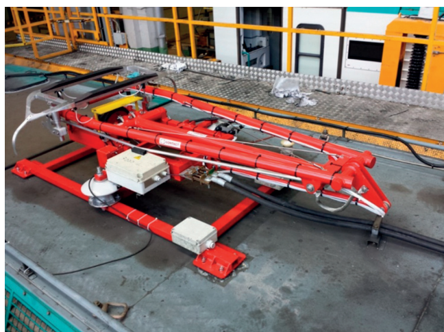
Fig. 3 - Installazione pantografo tipo JRC15 su locomotiva E464.430. Fig. 3 - Installation of the JRC15 type pantograph on locomotive E464.430.
