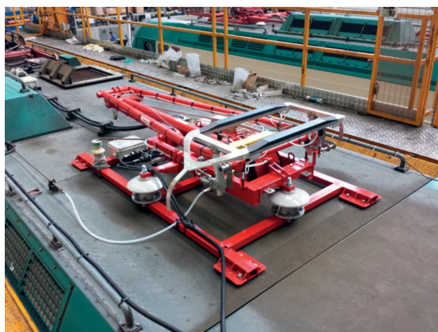
Fig. 4 - Installazione pantografo tipo JRC15 su locomotiva E464.430. Fig. 4 - Installation of the JRC15 type pantograph on locomotive E464.430.
