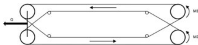
Fig. 9 - Schema del sistema funiviario con doppia fune portante traente.
