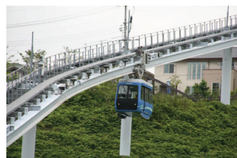
Fig. 12 - Il sistema Mitsubishi con via di corsa superiore e travi di lancio a motore lineare.
