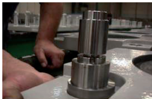
Fig. 10 – Installazione di una spina a rottura. Installation of a rupture pin.
