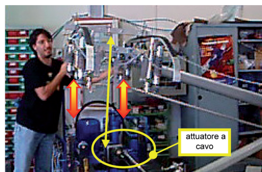
Fig. 25b - Disturbi in forza introdotti manualmente in parallelo all'azione dell'attuatore a cavo, (prove presso il fornitore autunno 2006).
