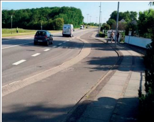
A - Pista ciclabile fianco fermata - Semi golfo (Fonte: http://www.ingdemurtas.it/bici/ciclabile-fermata-bus/ ) A - Cycle path next to the stop - Semi-full-width boarder (Source: http://www.ingdemurtas.it/bici/ciclabile-fermata-bus/ )
