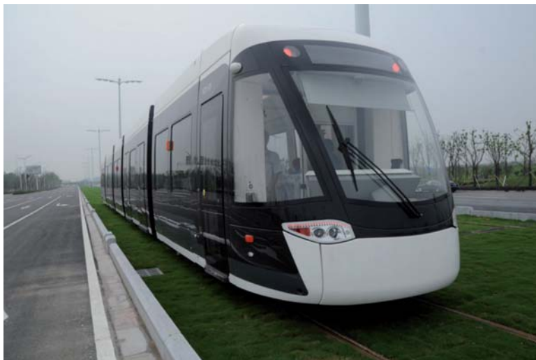
Fig. 4 - Il tram con trazione in assenza di catenaria in esercizio in Cina.
