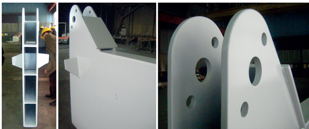
Fig. 29 - Prototipo del portale di copertura con il particolare dell'asola di ancoraggio alla struttura, realizzato dall'Impresa "Cimolai" - Pordenone.
