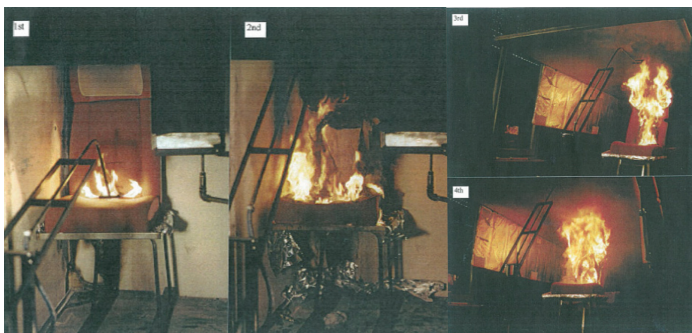
Fig. 8 - Propagazione dell'incendio nella seduta vandalizzata. Fire propagation in the vandalised seat.
