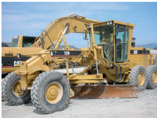
Fig. 10 - Motor grader utilizzato per la distribuzione del primo strato di pietrisco. Motor grader utilized for the distribution of the first ballast layer.
