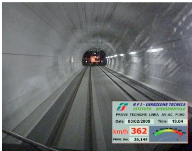
Fig. 27 - Snapshot con la velocità di punta di 362 km/h raggiunta nella corsa prova con il treno Y1 il 3 febbraio 2009. Snapshot with the maximum speed of 362 km/h reached by an Y1-type train during the test run of February 3 rd 2009.
