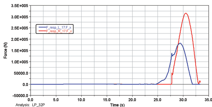
Fig. 14/c - Simulazione di frenatura in scambio: convoglio 32*50 t (1600 t), regime P/P. Forze longitudinali ai respingenti anteriori: carro 17. Simulation of the braking on a switch: 32*50 t (1600 t) convoy, P arrangement. Longitudinal forces on the anterior buffers: 17 th coach.
