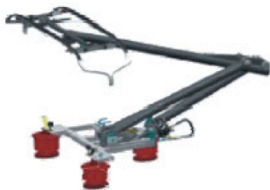
Fig. 3d - Prototipo di pantografo ferroviario con stadio di sospensioni attive/semiattive [12].
