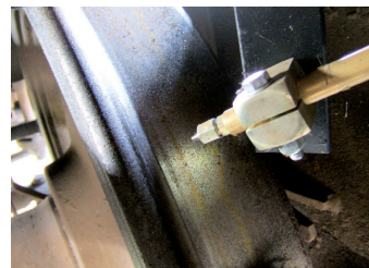
(Fonte Rowe Hankins & REBS) Fig. 2 - L'erogatore di lubrificante per la riduzione dell'attrito tra il bordino della ruota e fungo della rotaia).
