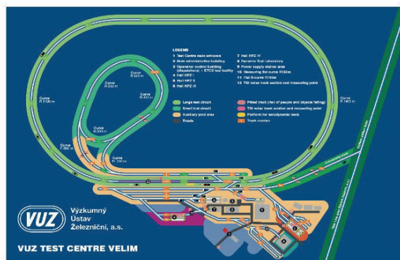
Figura 3 – Binari standard: circuito ceco di Velim (sinistra) e circuito polacco di Zmigrod (destra) [18][19].
