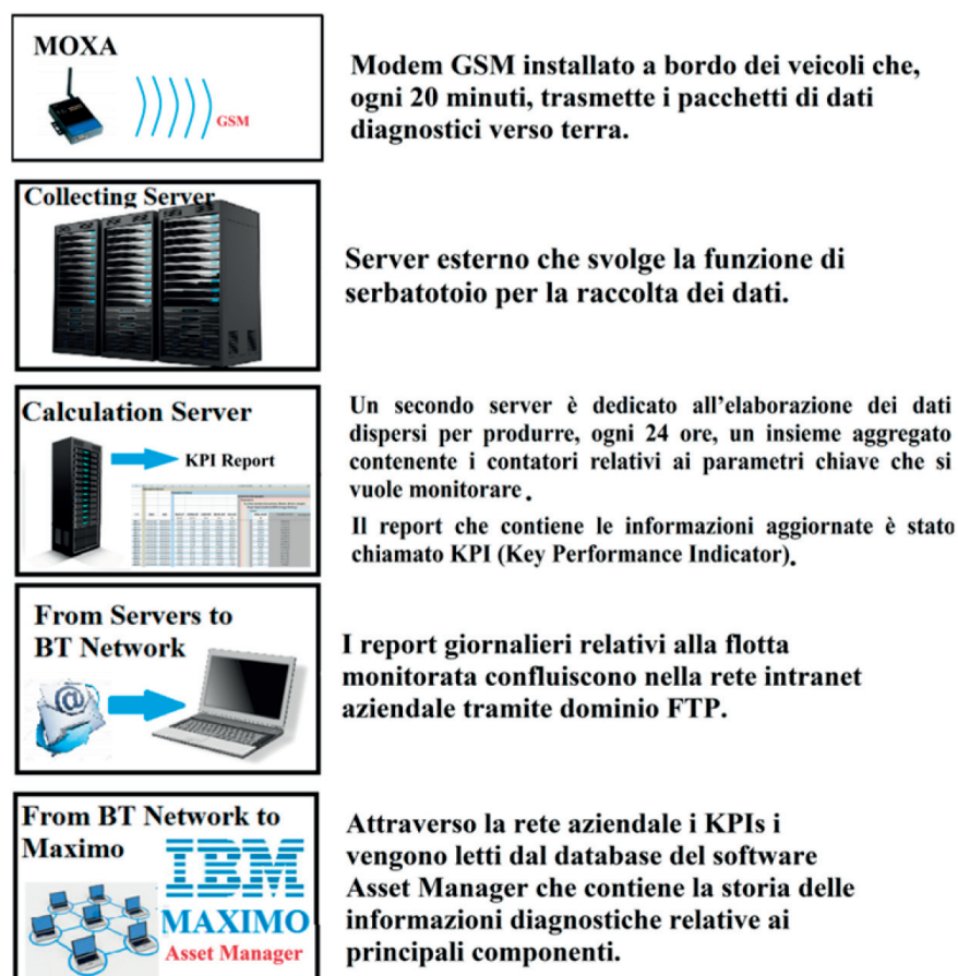
Fig. 3 - Schema a blocchi del sistema di monitoraggio on-line dei veicoli Bombardier.
