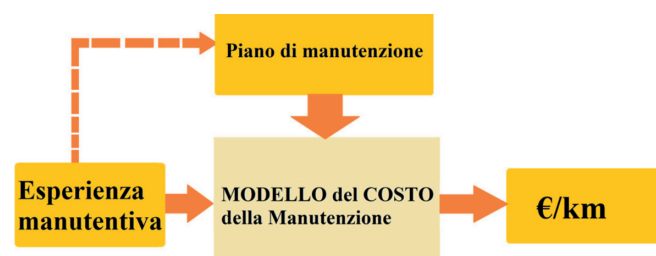
Fig. 7 - Attraverso il ritorno di esperienza dal campo si correggono le assunzioni presenti nel Modello del Costo della Manutenzione e si applica la revisione del Piano di manutenzione per adeguare gli interventi al reale stato degli asset.
