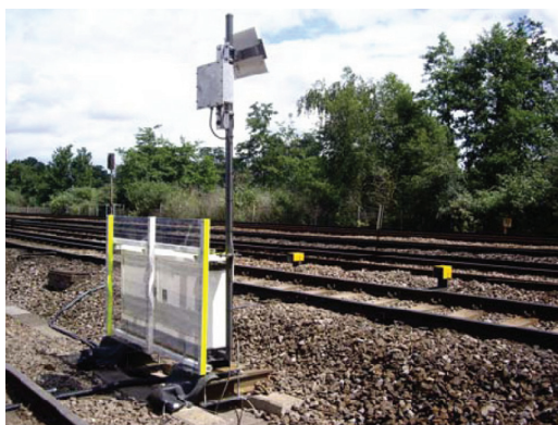
Fig. 6 - Sistema RailBAM per il monitoraggio acustico dei cuscinetti. RailBAM system for the acoustic monitoring of the bearings.
