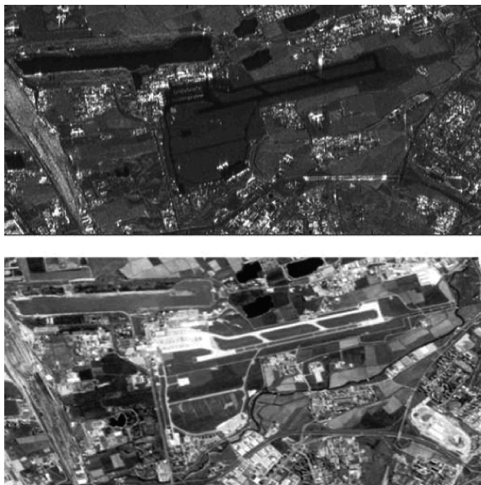
Fig. 1 - Linate-Idroscalo (Milano). Confronto tra acquisizione ottica (in basso) e acquisizione radar di tipo SAR (in alto). La direzione del nord è a sinistra dell'immagine. Linate-Idroscalo (Milano). Comparison between optical acquisition (top image) and SAR-type radar acquisition (bottom image). North direction is on the left of the image.
