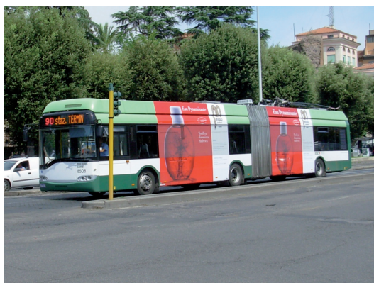
Fig. 4 bis - Il filobus nella tratta in marcia su batterie.
