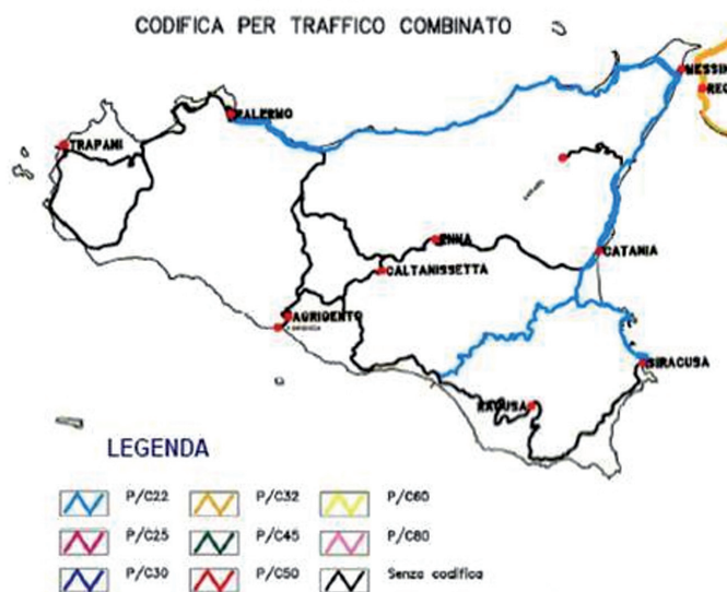
Fig. 13 - Sagome ferroviarie ammissibili nella rete ferroviaria siciliana. (Fonte: RFI (marzo 2003))
