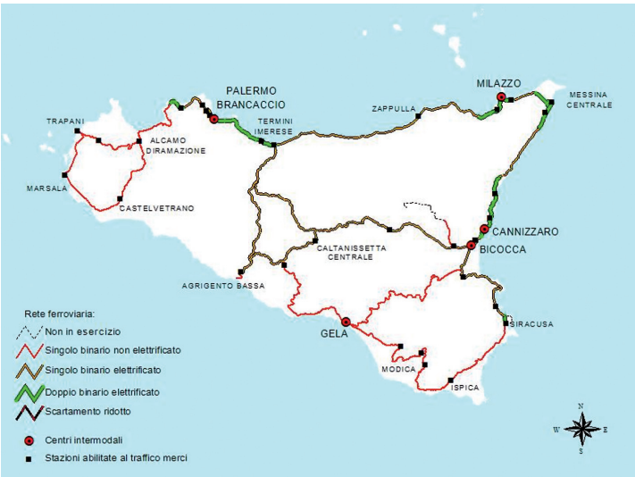
Fig. 11 - Linee ferroviarie, centri intermodali e stazioni abilitate al traffico merci in Sicilia nel 2003. (Fonte: TRENITALIA)
