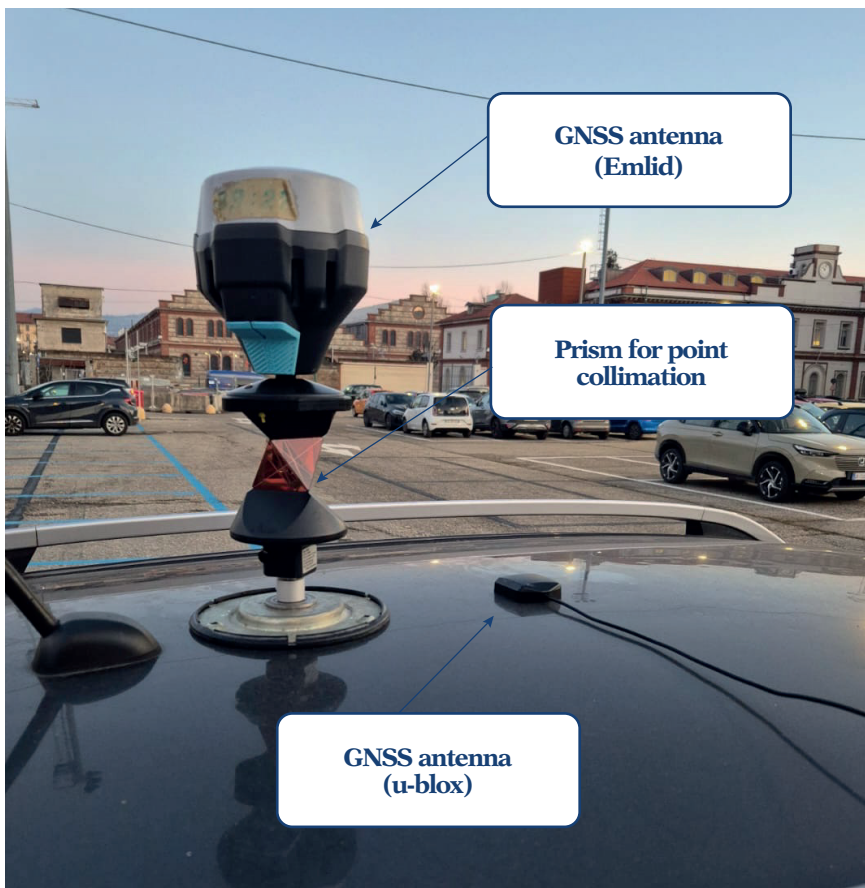
Figura 6 – Disposizione della strumentazione su veicolo stradale per la validazione del sistema GNSS.
