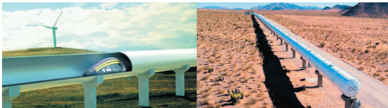
Figura 20 – A sinistra: la sezione del modello di Hyperloop [87]; a destra: pista di prova della Virgin Hyperloop nel deserto del Nevada [88].
