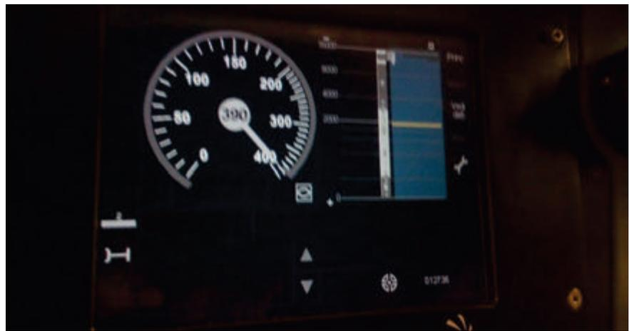
Fig. 6 - Foto DMI (Driver Machine Interface) dell'SSB con l'indice della velocità che ha raggiunto il valore di 390 km/h durante la corsa.
