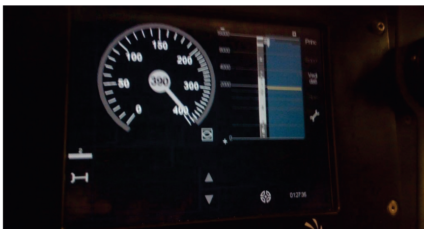
Fig. 6 - Foto DMI (Driver Machine Interface) dell'SSB con l'indice della velocità che ha raggiunto il valore di 390 km/h durante la corsa.
