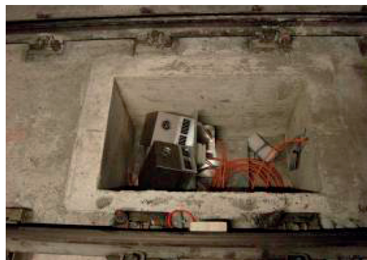
Fig. 6 - Modulo Termografico: IRS 350-2. Fig. 6 - Thermograph Module: IRS 350-2.
