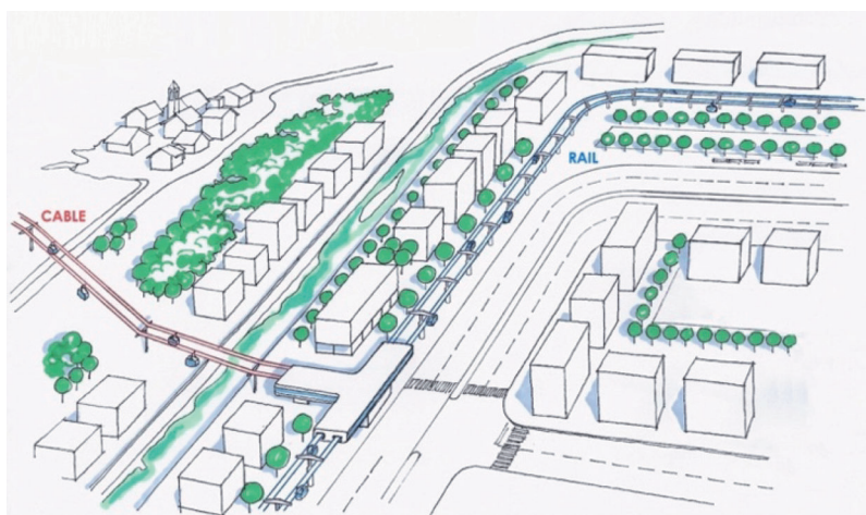
Figura 14 - Bozzetto di un'installazione di sistema CableSmart: la linea è disegnata in rosso nella sua parte funiviaria, e in blu nel suo segmento su rotaia.
